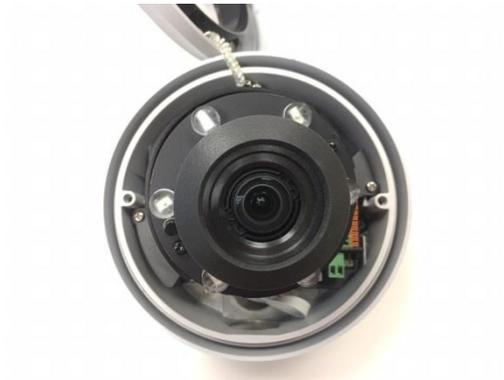
9. Ajuste el ángulo de la lente agarrando la base, y girando horizontal y verticalmente. Ajuste la rotación de la lente.
