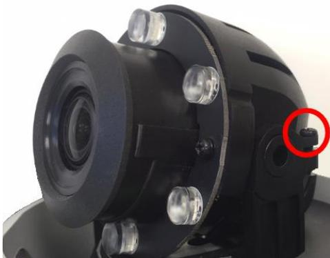
7. Instale la correa del domo si se retiró, la cubierta del domo y apriete los tornillos de la cubierta del domo.
