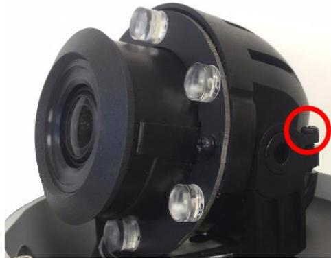
11. Fije la cadena anticaídas, coloque la cubierta del domo y apriete la cubierta del domo.
