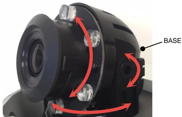
10. Apriete el tornillo de bloqueo para fijar la posición del módulo de cámara.
